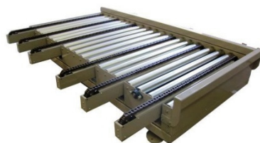
Equipo transferizador siendo el transporte con rodillos y la transferencia con cadena
